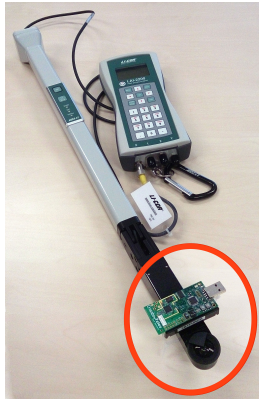
(a) Setup für die direkte Vergleichsanalyse zwischen TelosB-basiertem Sensor und LAI-2200.
