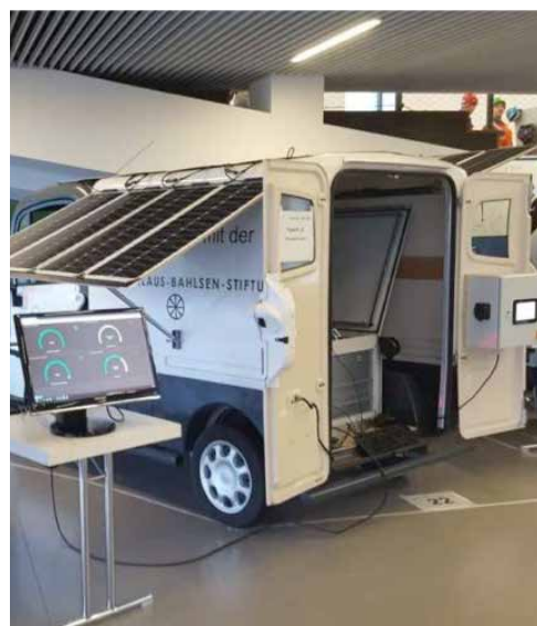
Abb. 2: Als mobile Ladesäule umgerüsteter Transporter
