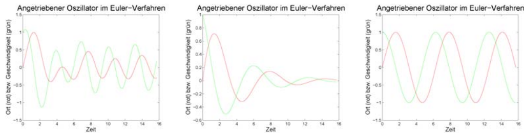
Abbildung 1.5: Erzwungene Schwingung (numerische Lösungen): der Einschwingvorgang mit dem Übergang zur erzwungenen Schwingung ( links ); ohne externe Anregung ergibt sich eine gedämpfte Schwingung, entsprechend der Lösung der homogenen DGL ( Mitte ); mit verschwindender Reibung und Anregung, entsprechend der freien Schwingung ( rechts )
