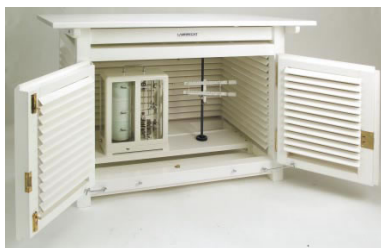
Abbildung 2.1: Wetterhütte mit Instrumentierung http://www.swisswetter.ch/mall/images/wetterhuetten-wmo-01.jpg
