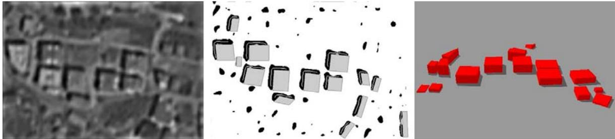
Auf Basis von Cartosat-Satellitenbildern (links) werden durch Schattenanalyse approximativ 2D-Grundrisse (Mitte) und 3D-Gebäudemodelle (rechts) vom Testgebiet Istanbul zum Zweck der Veränderungsanalyse erzeugt.
