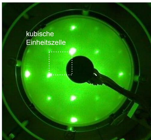
**Abbildung 6.2** LEED Aufnahme einer MgO(001) Oberfläche. Nach der Reinigung durch Heizen ist die kubische Oberflächeneinheitszelle eindeutig zu erkennen. Es wurde eine Elektronenenergie von 158 eV benutzt. Das Substrat ist somit hinreichend kristallin. Die Elektronenenergie wurde zunächst auf etwa 300 eV erhöht, ebenso wurde eine hohe Emission gewählt. Nachdem dann die Oberfläche leitend und das Beugungsbild sichtbar wurde, konnten beide Werte entsprechend reduziert werden.
