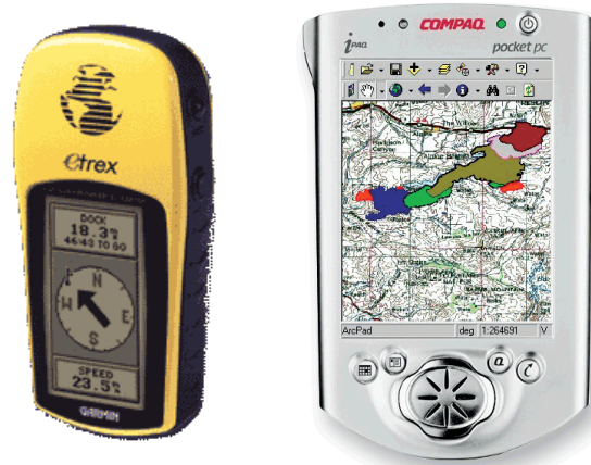
Abb. 6.3: Mobile Geräte für die Navigation. Links: GPS-Gerät. Rechts: PDA basierend auf Windows Mobile. Quelle: http://www.cotswoldoutdoor.com und http://www.esri.com .
