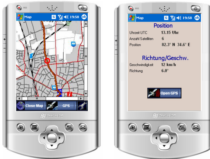
Abb. 6.6: Das mobile FahrradNavigationssystem FNaS . Links: Anzeige der Karte und dem GPS-Punkt (roter Kreis). Rechts: Informationen über empfangene GPS-Daten. Quelle: VARNHORN 2006.
