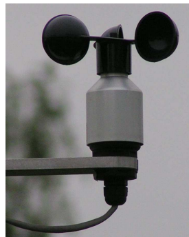
Abbildung 7.4: Anemometer zur Messung der Windstärke
