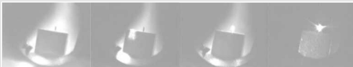
Abbildung 2.2.3: Kamerablick auf die Cantileverrückseite bei der Justage des Spiegel 1.
