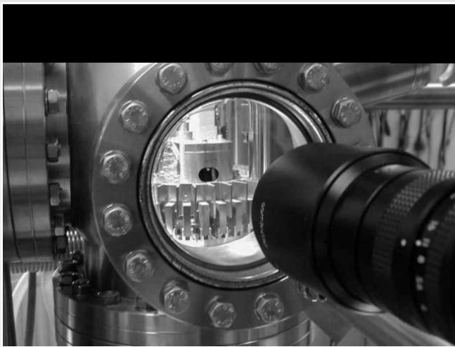
Abbildung 2.2.2: Seitlicher Blick in die AFM-Kugel, rechts im Bild ist das Objektiv der Videokamera und die ovale Öffnung im „Lichtzeigergehäuse“ zu sehen.
