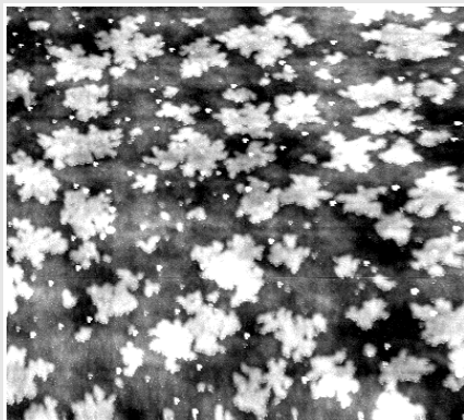
Abbildung 3.2.25: Topografie, Amplitudensollwert: 0,05 Volt, 3 \times 3 \mu\text{m}^2 , df : - 20 Hz, Grauskala: 0 – 2,5 nm
