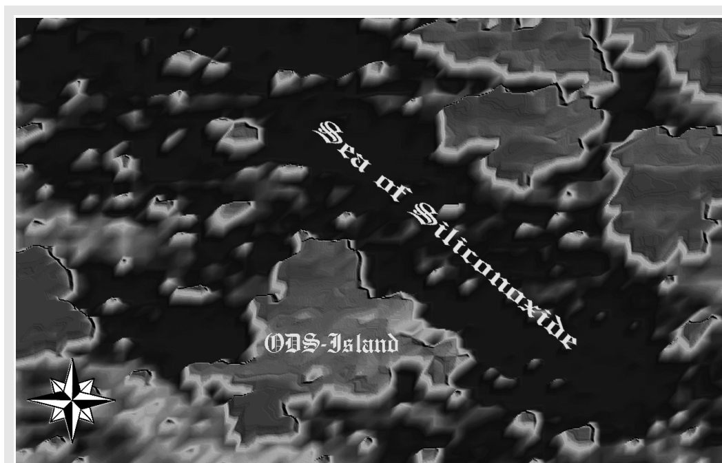
„Seekarte“ aus einem Topografiebild einer AFM-Messung, es zeigt die charakteristischen Strukturen des organischen SAM's (ODS) auf dem Siliziumoxidsubstrat.
