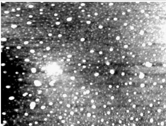
Abbildung 2.2.18: Polyethylen-Folie mit aufgedampftem Aluminium (maschinell erstellt, Mitsubishi) Topografie, 2 \times 1,5 \mu\text{m} , Grauskala 0-45 nm, vorwärts, die hellen Partikel entsprechen dem Aluminium, der Untergrund ist PE-Folie.
