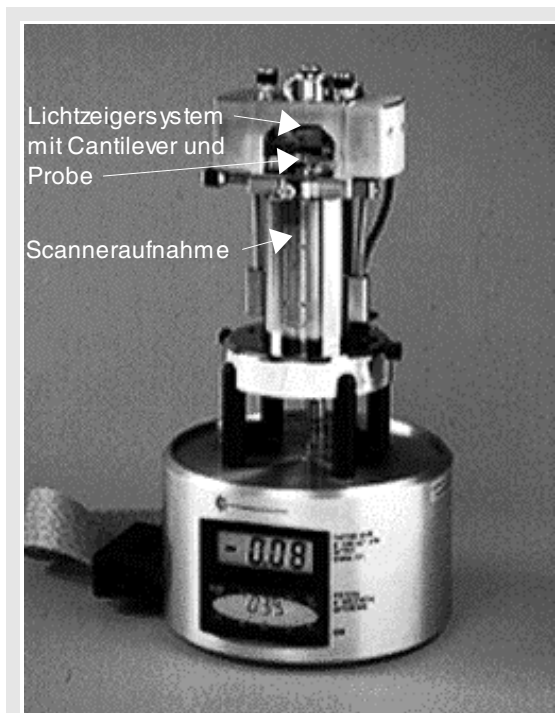
Abbildung 1.1.4: Foto des Nanoscope Multimode 3. Im oberen Bereich ist die Probe, die Spitze, das Lichtzeigersystem und der Scanner zu sehen, im unteren Bereich ein Teil der Elektronik mit einem Anzeigedisplay. Das Gerät ist ca. 30 cm hoch und ca. 10 cm breit. Quelle: Digital Instruments
