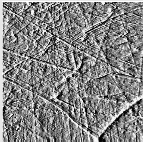
Abbildung 2.2.10: F-F_0 , Grauskala: 0,086 – 0,118 nN. Das normierte Kraftsignal zeigt deutlich mehr laterale Information als das Topografiebild.
